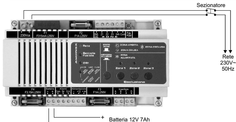
Ad impianto ultimato va collegata la batteria in morsettieria tramite due conduttori muniti di capicorda tipo *faston*. Fare attenzione alla polarità di collegamento (Rosso = [+] positivo batteria / Nero = [-] negativo batteria), onde evitare di danneggiare in modo serio i dispositivi collegati.
